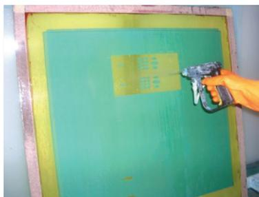
**Paso 1.** Después de la eliminación de tinta, bloqueo, y cinta adhesiva, aplique Eco-Strip®C a una pantalla húmeda (ambos lados).
