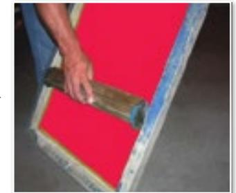
Poco a poco capa 4 veces, llenando la malla con emulsión. Entoces, para evitar burbujas de aire en la pantalla, raspar el exceso de emulsión del lado de el estampado con otra capa. El exceso de emulsión s debe mantener para su uso posterior después, que sin secado, capa como 6-18 veces en el lado interior, forzando la emulsión hacia el exterior, creando una capa gruesa
