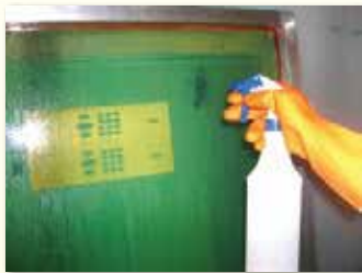
1. Rocíe ENVIROWASH en ambos lados de la pantalla.
