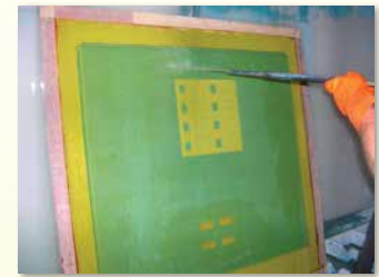
3. Enjuague de alta presión comenzando en la parte de abajo.
