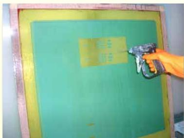
1) Después de la eliminación de la tinta, el bloque de salida, y la cinta, aplicar **GEM-ZYME** a una pantalla húmeda (ambos lados).
